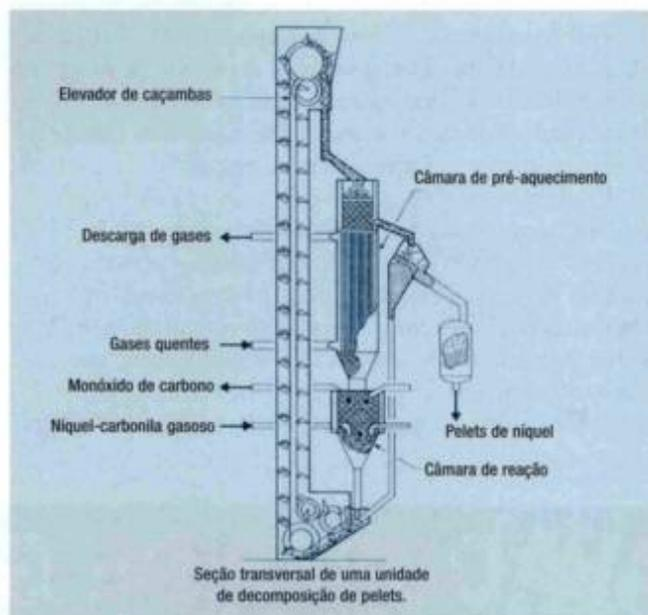
Fig. 1 – Desenho esquemático de uma unidade de decomposição de pelets na Refinaria de Níquel Clydach, Clydach, País de Gales, Grã-Bretanha
