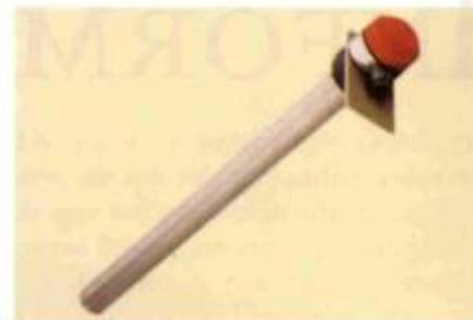
Indicadas para banhos altamente agressivos, as resistências “SBE Titânio”, da **SMS Resistências Elétricas**, possuem elemento tubular em aço inoxidável, cápsula em tubo de titânio com diâmetro de 50 mm, altura de 600 a 2000 mm e potência de 1000 a 6000 W. Apresentadas nos tipos monofásico ou trifásico, atuam com tensão de alimentação de 220, 380 ou 440 V.
