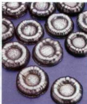
Material de anodo ativado, o níquel eletrolítico **S-Rounds** da **Inco**, comercializado pela **Citra**, é indicado para galvanoplastia com cestas, sendo a dissolução ativada pelo codepósito de uma pequena quantidade controlada de enxofre com o níquel durante o processo de eletrometalurgia. É apresentado na forma de botões com aproximadamente 25 mm de diâmetro e 6,5 mm de espessura.
