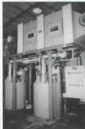
de gases nitrosos, com duplo estágio de neutralização e comando automático de dosagem dos reagentes. Inclui tanques auxiliares, agitadores mecânicos, sensores, painel de comando geral, válvulas solenóides, estrutura de sustentação e tubulações de interligação.
