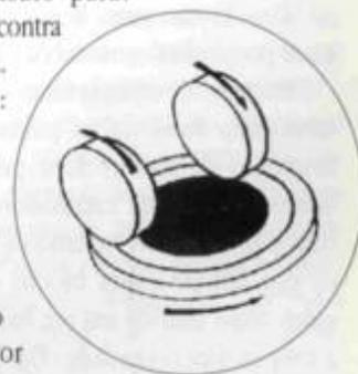
Figura 1 — O "Taber Abraser" utilizado para ensaiar a resistência das superfícies contra abrasão seca.
