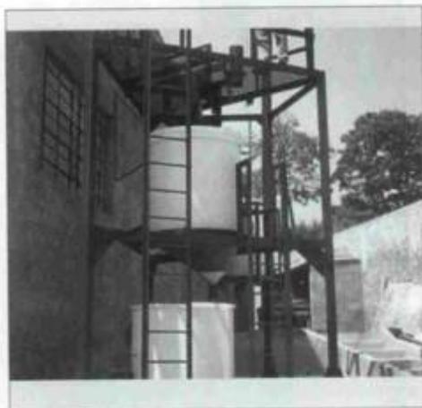
Voltada para a solução de problemas ambientais, a **Apliquim Equipamentos e Produtos Químicos** fabrica e instala unidades compactas para o tratamento de efluentes de indústrias de galvanoplastia e anodização, sendo que cada uma delas é entregue completamente montada em dois meses e ocupa área de 3x3 m de piso, sem requerer fundações especiais. A empresa também pode se encarregar da destinação dos lodos resultantes das operações de tratamento de efluentes.
