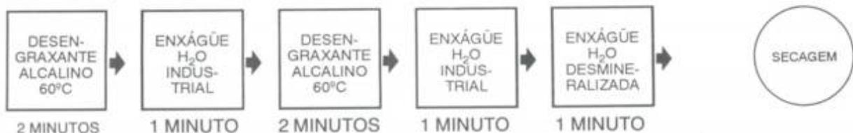
Fluxograma 1 - Sistema Power Wash de Limpeza
