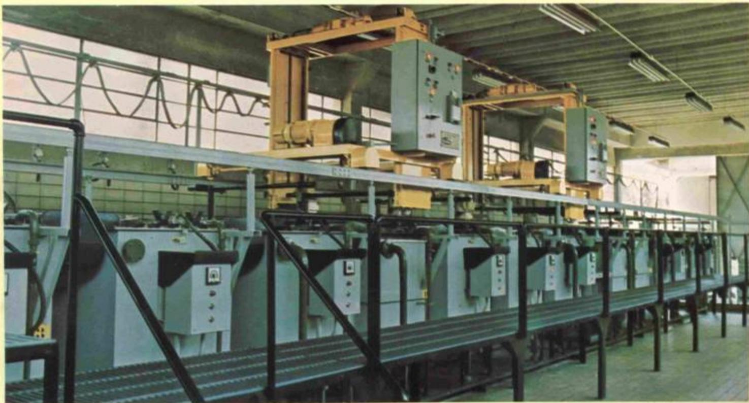
Quando se trata de galvanoplastia, anodização, fosfatização, etc., - as instalações automáticas da Elquimbra, operadas por circuitos eletromagnéticos, asseguram lucrativas vantagens. -
