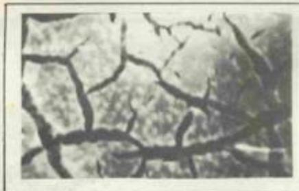
Figura 29 — Oxidação da resina (5.000 X)
