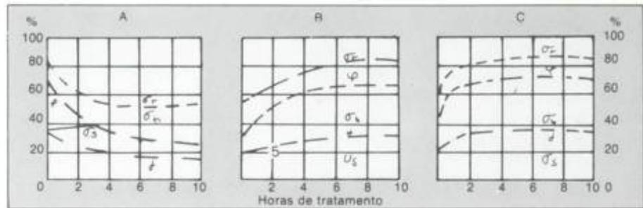
Figura 8 — Influência de absorção de hidrogênio e de tratamento a 100°C e 200°C nos valores de tração. (A) Tempo de absorção de hidrogênio. (B) Tempo de tratamento térmico a 100°C. (C) Tempo de tratamento térmico a 200°C.
