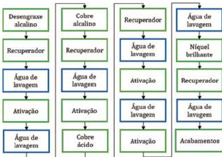
Figura 1. Fluxograma do processo de tratamento de superfície
