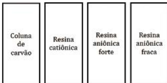
Figura 2. Banco de resinas de troca iônica instalado.
