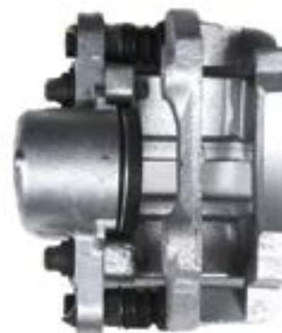
Figura 3: Componente de freio zincado feito de ferro fundido
