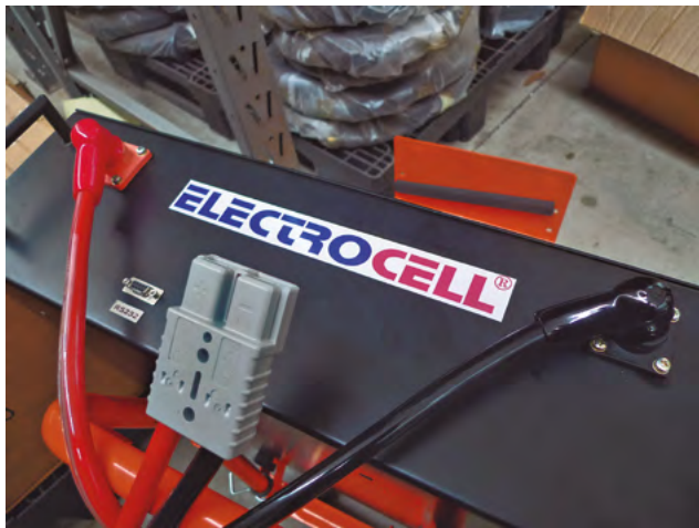
Figura 3: bateria para empilhadeira da Electrocell 25,6V@200Ah
