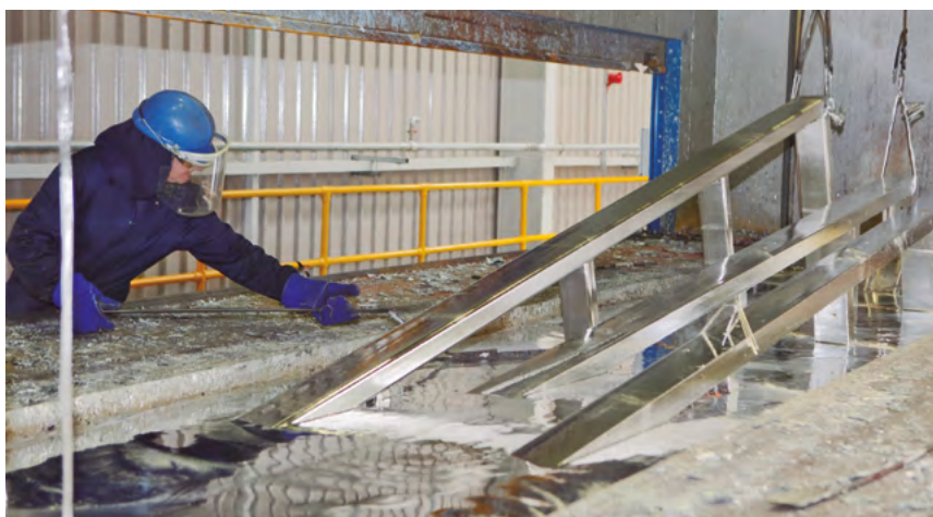
Ilustração do banho de uma estrutura metálica em aço no zinco fundido
