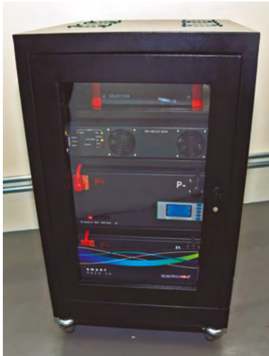
Figura 2: unidade de bateria de íon-lítio de 10kWh da Electrocell
