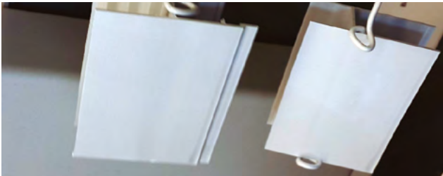
Peças que sofreram o processo de fosqueamento em alta concentração de Al, removendo completamente as linhas de extrusão e conferindo à superfície excelente acabamento
