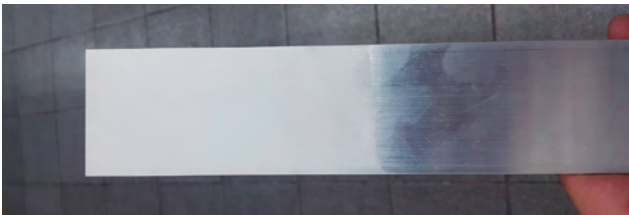
Comparativo da superfície antes e depois do processo de fosqueamento
