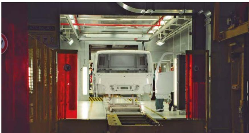
Tratamento de superfície da carroceria (pré-pintura) na fábrica de caminhões da Mercedes-Benz, em Juiz de Fora (MG)
