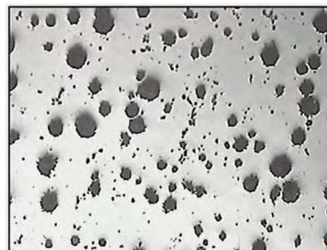
Figura 7. Microestrutura do ferro fundido base, na qual denota a presença de micro-rechupes. Aumento: 100 x. Ataque: sem ataque
