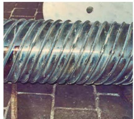
8. Miolo interno de cilindro com sistema helicoidal para refrigeração uniforme
