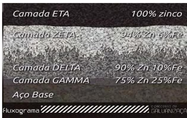
Figura 1 - Camadas intermetálicas, galvanização a fogo não contínua
