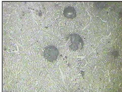
Figura 5. Microestrutura ADI, composta de ferrita acicular (escura) e austenita retida (clara). Aumento 400x. Ataque Nital 2%
