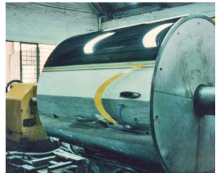
3. Recuperação de cilindros chill-roll até 1400 mm de diâmetro, espelhado com rugosidade Ra 0,001mm, usado para fabricação de filmes bi-orientado
