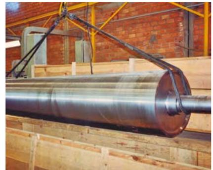
2. Cilindros fabricados no Brasil, com tecnologia avançada, circulação helicoidal interna para homogeneização da temperatura na face externa
