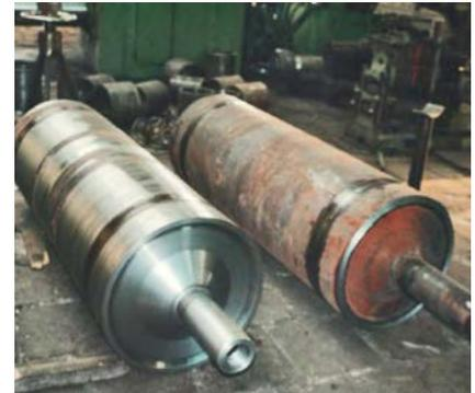
10. Cilindros montados para continuação do processo de fabricação 🚩
