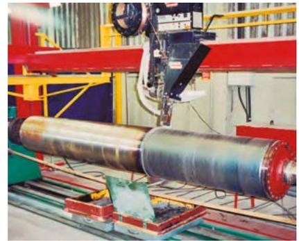
1. Revestimento bi-metálico duro, substituindo tratamento térmico e usando tubos de chapas SAE 1020 calandradas
