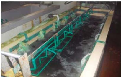
Figura 3: Típico equipamento de deposição eletrolítica.
