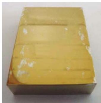
Figura 7: Peça metálica previamente cromada com posterior revestimento dourado de TiN com evidentes falhas de delaminação.
