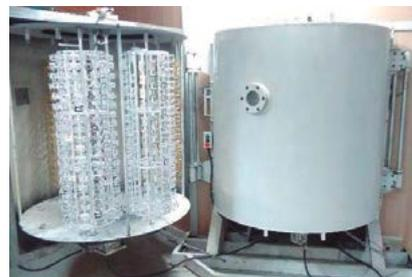
Figura 2: Típico equipamento de metalização a vácuo de duas portas, no qual uma delas está com as gancheiras prontas para receberem peças e a outra está fechada, realizando o processo.
