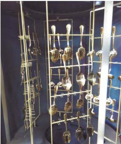
Figura 6: Equipamento de porte industrial de PVD por arco catódico no qual uma carga acabou de ser revestida com TiN dourado.
