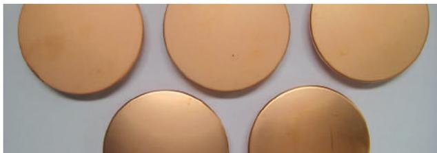
Figura 6. Peças depositadas com a 2ª geração de cobre acetinado. A partir da esquerda, o aumento do brilho é devido ao aumento do tempo de deposição na 2ª etapa de deposição de cobre (0 min, 5 min, 10 min, 15 min e 20 min)
