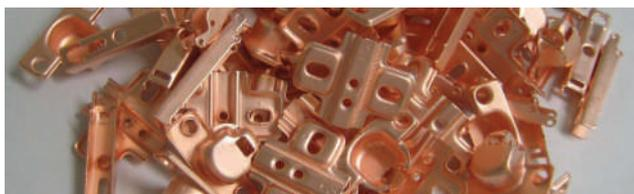
Figura 7. Peças depositadas em tambor rotativo com a 2ª geração de cobre acetinado
