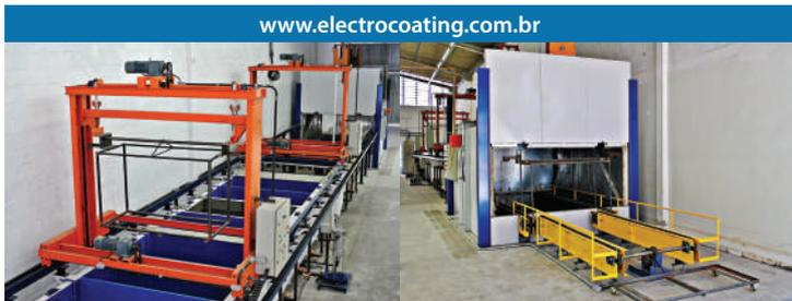
A Electrocoating desenvolveu este sistema modular de tratamento de superfície e pintura KTL (E-coat), que é composto por módulos independentes de pré-tratamento, de pintura e estufa, no qual tem grandes vantagens em relação aos existentes no mercado (Pat. Req.)
