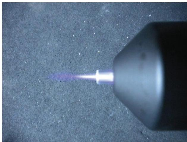
Figura 4: Tocha de plasma atmosférico a 25°C – Imagem: Surface - Engenharia e Soluções a Plasma Ltda.
