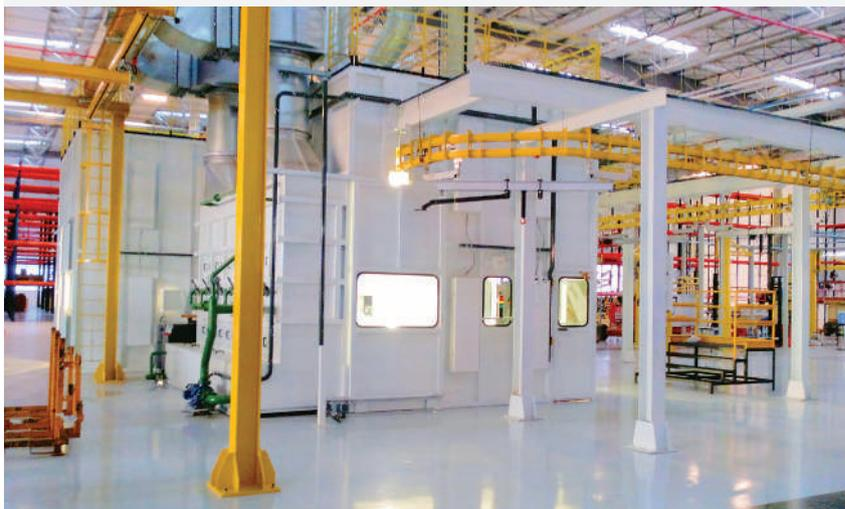
A instalação possui cabine de pintura dupla/oposta com dois robôs para a aplicação de tinta, um de cada lado, e um transportador aéreo tipo power & free para 1,5 tonelada por carga.
