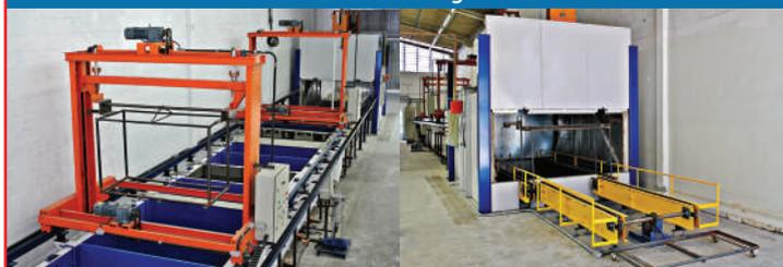
A Electrocoating desenvolveu este sistema modular de tratamento de superfície e pintura KTL (E-coat), que é composto por módulos independentes de pré-tratamento, de pintura e estufa, no qual tem grandes vantagens em relação aos existentes no mercado (Pat. Req.)
