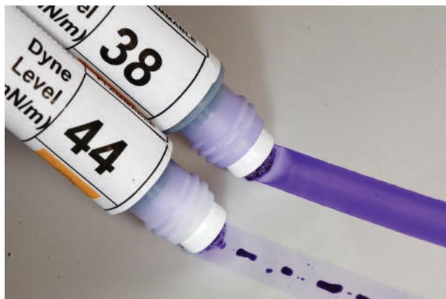
Figura 2: Canetas “dyne” ilustram o efeito de dispersão superficial. A descontinuidade apresentada à esquerda significa baixa propriedade de adesão. Já no traço localizado à direita, a superfície possui boas propriedades de adesão.
