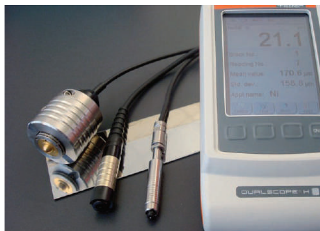
Figura 1: Diversas sondas manuais para a medição da espessura de camadas de NiP (à esquerda a sonda para a retrodispersão de radiação beta, no centro a sonda Hall magnética e à direita a sonda magnetointutiva)
