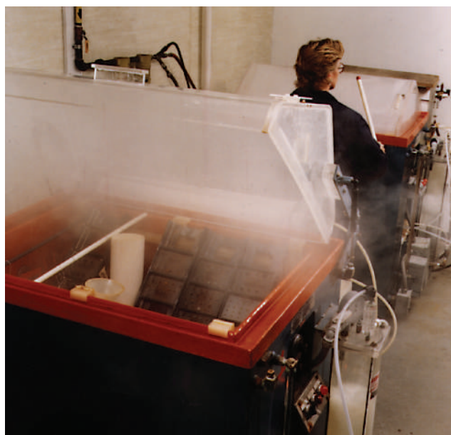
O ensaio de névoa salina (ASTM B-117) é um elemento chave no processo de controle de qualidade de parafusos revestidos
