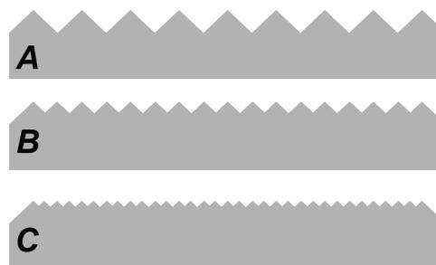
Figura 4 - Acabamento adequado, três etapas de usinagem (A, B e C)
