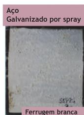
Aço rugoso à esquerda e no meio, aço galvanizado à direita. Tinta em pó base poliéster com cerca de 60 micrometros. Fotos após 500 horas do ensaio em névoa salina
