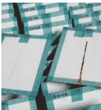
Painéis metálicos de alumínio e de aço são continuamente analisados após ensaios de névoa salina e comparados ao longo de um período de 500-2000 horas quanto a qualquer deterioração corrosiva ou defeitos na superfície metálica
