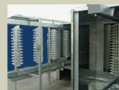
Estufas de cura por UV, infravermelho e térmico
