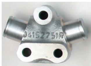
Figura 3: Decapagem com ácido clorídrico com fluoretos
