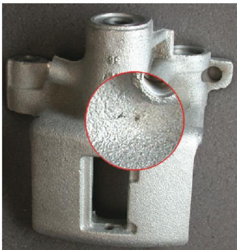
Figura 1: Pinça de freio de disco com defeito aparente no material-base depois da eletrodeposição de zinco ácido
