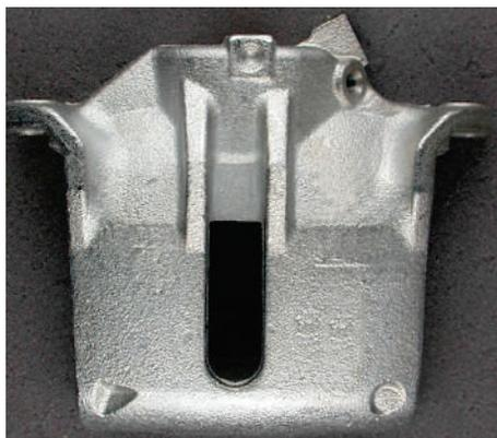
Figura 7: Carcaça de freio com ZnNi levemente ácido a base de KCl-Ni aplicado diretamente, passivado com passivação transparente
