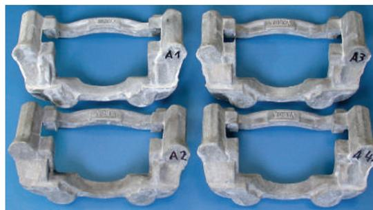
Figura 9: Suporte de ferro fundido após 1000 horas em ensaio de névoa salina conforme DIN EN ISO 9227 NSS
