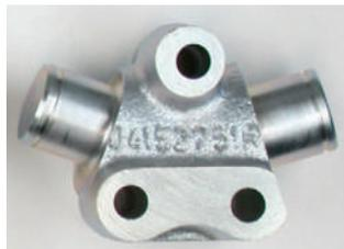
Figura 5: Decapagem com misturas de ácidos com fluoretos
