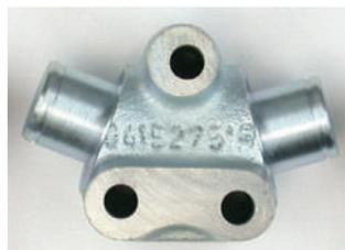
Figura 4: Decapagem com misturas de ácidos sem fluoretos
