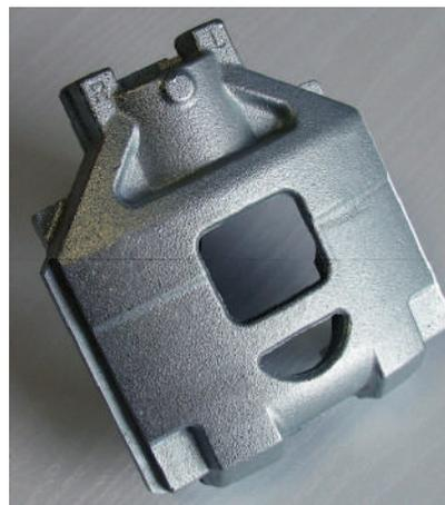
Figura 6: Pinça de freio eletrodepositado com zinco levemente ácido seguido por um passivação trivalente azul
