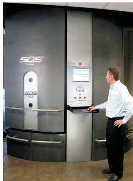
Figura 3 - Reator de nitretação utilizado para tratamento
