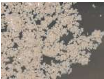
Figura 3 - Flocos formados após reação de eletrocoagulação-flotação
