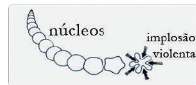
Esquema do fenômeno de cavitação: geração de uma microbolha de vácuo
