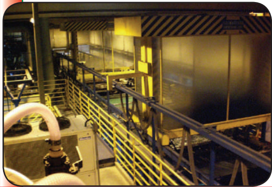
Bertoli: o processo de pintura E-Coat/KTL tem elevada resistência à corrosão, podendo superar 1000 horas de névoa salina
