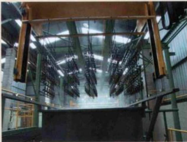
Tanque de tinta para 10 000 litros usado no setor
