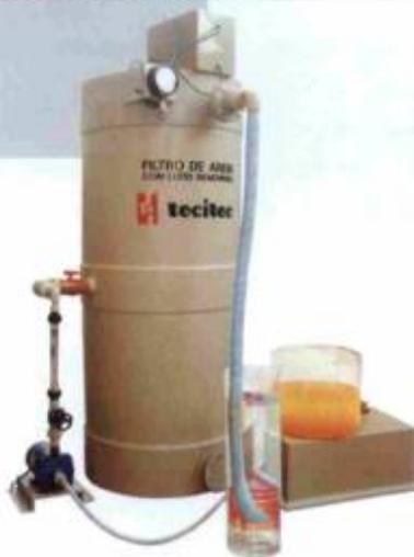
O novo filtro de areia com leito renovável fabricado pela **Tecitec** é usado na filtração contínua de água e efluentes, eliminando as paradas para retrolavagem. Fabricado em polipropileno e aço inox, opera em regime de pressão constante e, segundo a empresa, elimina o reservatório de água filtrada para contracorrente e a bomba de alta vazão para lavagem, além dos controles PLC, pressostatos, temporizadores e controle de nível.
