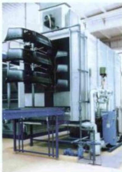
Fig. 5 - Entrada de túnel de pré-tratamento - linha de pintura de pára-choques
