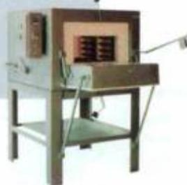
Os fornos tipo mufla da **Resiluz** são indicados para a fusão de metais não-ferrosos, tratamento térmico, incluindo têmpera e revenimento, e de peças, podendo ser fornecidos com resistência de fita ondulada, em placa refratária e especiais. Podem operar em temperatura de até 1 200° C e são produzidos em diversos tamanhos.
