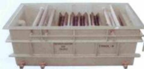
O separador de óleo possui lamelas especialmente projetadas, fabricadas em polietileno, de fácil montagem e limpeza. Orifícios localizados nas cristas das lamelas permitem a passagem do óleo retido, até que chegue à superfície na região de coleta.
