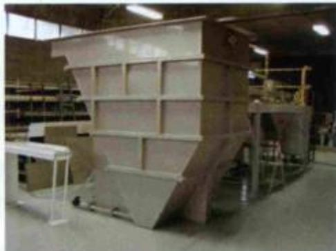
Nas estações automáticas, a floculação ocorre de modo contínuo no compartimento de floculação do floco-decantador de lamelas, e a decantação ocorre de modo contínuo no decantador.
