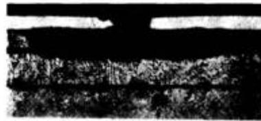
Figura 17 - Corrosão confinada à camada intermediária no revestimento triplex de níquel sob o revestimento de cromo no ensaio com a lama corrosiva.
