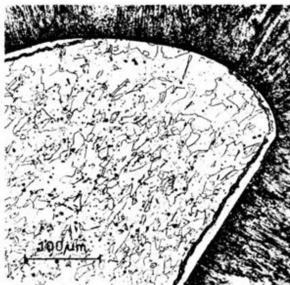
Fig. 1 — Seção transversal de uma armação de óculos fabricada com double em ouro. Foi cuidadosamente polido para demonstrar o local onde foi desgastada inteiramente a camada de ouro.
