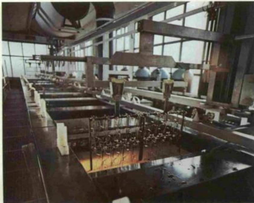
Fig. 2 — Linha galvânica inteiramente automática para deposição de ouro puro ou liga de ouro em armações de óculos já montadas. A linha também é utilizada para executar rodinagem em armações folhadas em ouro branco ou produzidas em double branco de ouro. Baseando-se em um turno de trabalho, esta instalação tem capacidade para produzir 10<sup>6</sup> armações por ano.
