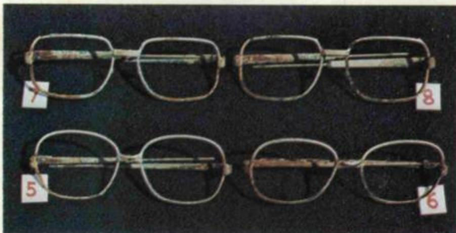
Fig. 3 — Armações de óculos folhadas a ouro 18 quilates, liga Ouro/Cobre/Cádmio (3 microns nas amostras 5 - 7 e 5 microns nas amostras 6 - 8, após 100 horas de exposição no teste CASS.
