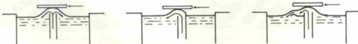
Fig. 12—Três formas diferentes de ondas usadas para soldagem por onda de placa de circuito impresso. A maioria do equipamento comercial possui uma variedade de bocais diferentes para se ajustar a aplicações diferentes.
