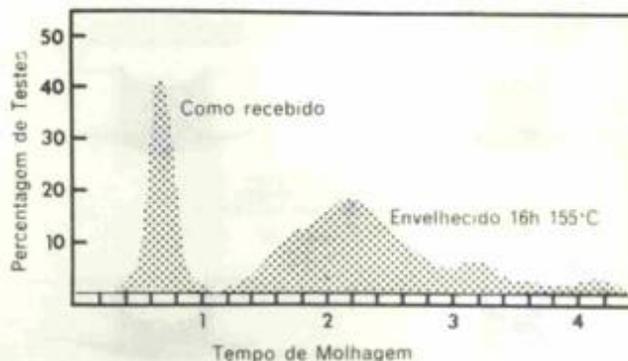
Fig. 11—Distribuição de tempos de molhagem no teste de glóbulos em 50 espécimes de um lote nas condições de recebimento e após envelhecimento durante 16 horas a 155°C (311°F). Esse tratamento de envelhecimento é uma opção no padrão B.S. 2011. Nota: Os terminais eram de fio de cobre chapeados com 0,0001 pol. de 30/70 estanho chumbo testados com solda 60/40 a 235°C (455°F) e fluxo de resina-isopropanol.
