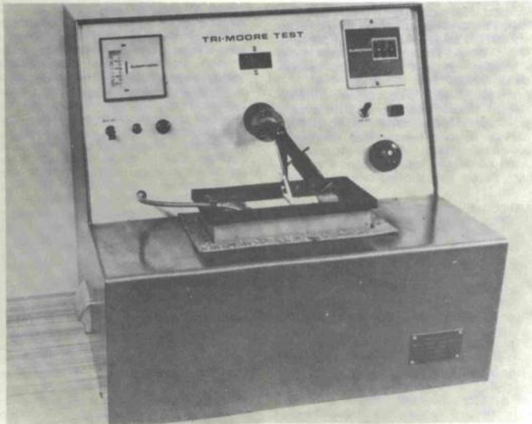
Fig. 6—Teste de soldabilidade de mergulho rotativo para espécimes e rótulos de circuito impresso designado por teste TRI-Moore. Uma pá "pfté" (plástico tipo Teflon) precede o espécime de imediato para limpar a superfície do banho de solda dos resíduos de óxido e fluxo. A soldabilidade dos furos vasados e chapeados pode ser também determinada. (Fotografia por Cortesia do Tin Research Institute e de W & E Moore Ltd.).
