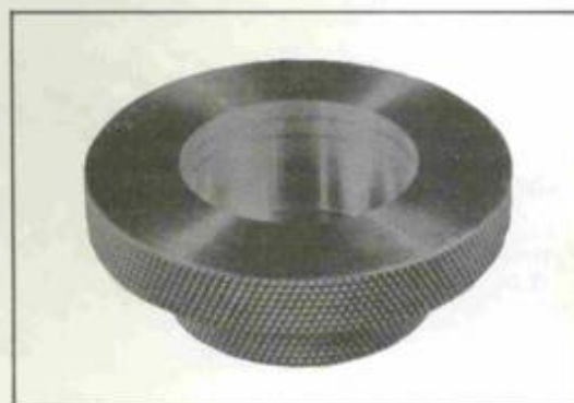
fig. 11 copo de permeabilidade usado para o ensaio de amostras pequenas.
