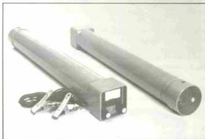
fig. 9c modificação do detector de descontinuidade. Aparelho usado especificamente para a detecção de descontinuidade de revestimentos dielétricos de tanques e tubulações de armazenamento de produtos químicos corrosivos como ácidos e álcalis. Opera pelo princípio de que quando dois metais diferentes são imersos em um ácido ou alcali ativo geram entre si uma pequena tensão, a qual é usada pelo aparelho para ativar um micro-amperímetro ou um alarme sônico.
