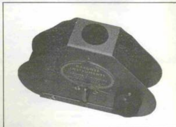
fig. 10 aparelho de JACOBSEN modelo redondo usado para a determinação do chalking de películas.
