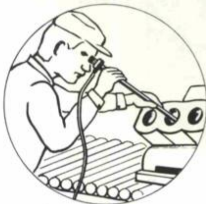
Fig. 4 — Esquemático da inspeção feita com um tuboscópio.
