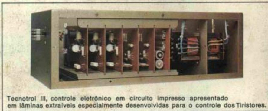
Tecnotrol III, controle eletrônico em circuito impresso apresentado em lâminas extraíveis especialmente desenvolvidas para o controle dos Tiristores.
