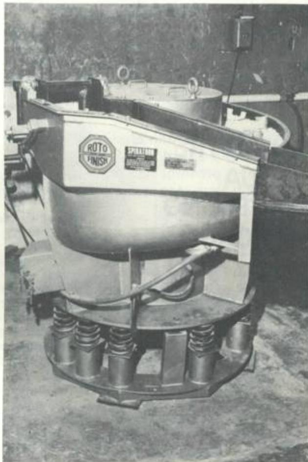
Aa lado, comparação entre uma peça em bruto e uma peça já processada. Acima: o Spiratron. Observe-se o jogo de molas para amortecer as vibrações.
