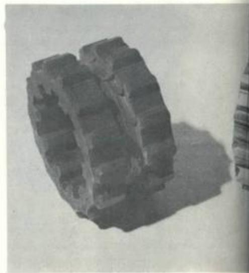
têm raízes fortes, estas podem ser quebradas e niveladas no processo de tamboreamento, sem necessidade de uma operação de lixamento anterior.
