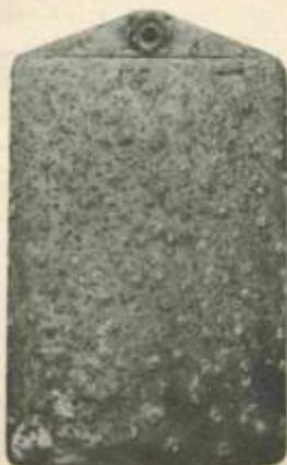
os casos, formam-se células locais de corrosão fixas, de modo que a corrosão se processa de maneira bem localizada.
