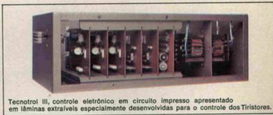
Tecnotrol III, controle eletrônico em circuito impresso apresentado em lâminas extraíveis especialmente desenvolvidas para o controle dos Tiristores.
