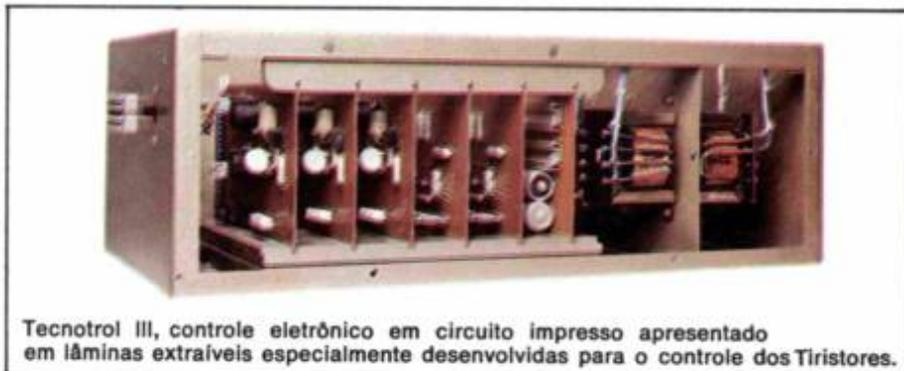
Tecnol III, controle eletrônico em circuito impresso apresentado em lâminas extraíveis especialmente desenvolvidas para o controle dos Tiristores.
