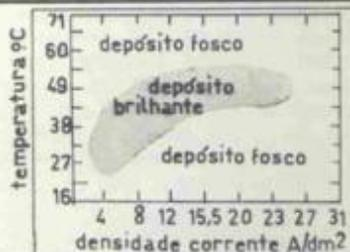
Para produzir depósitos brilhantes a 120°F, em uma densidade de corrente catódica de 0,4A/dm² a 1,5A/dm², é satisfatória. Se a temperatura cair para 80°F, a densidade de corrente máxima deverá ser de 0,4A/dm². O efeito da temperatura na velocidade de deposição é mostrado no slide seguinte.
