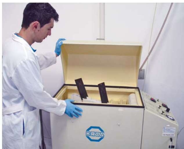
Figura 2 - Solução para Ensaio CASS.
