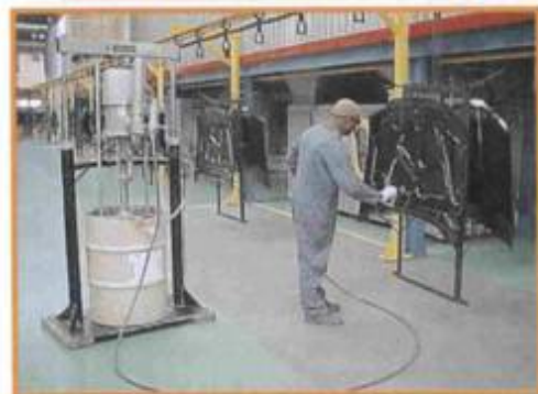
Aplicação de selantes a base de PVC
